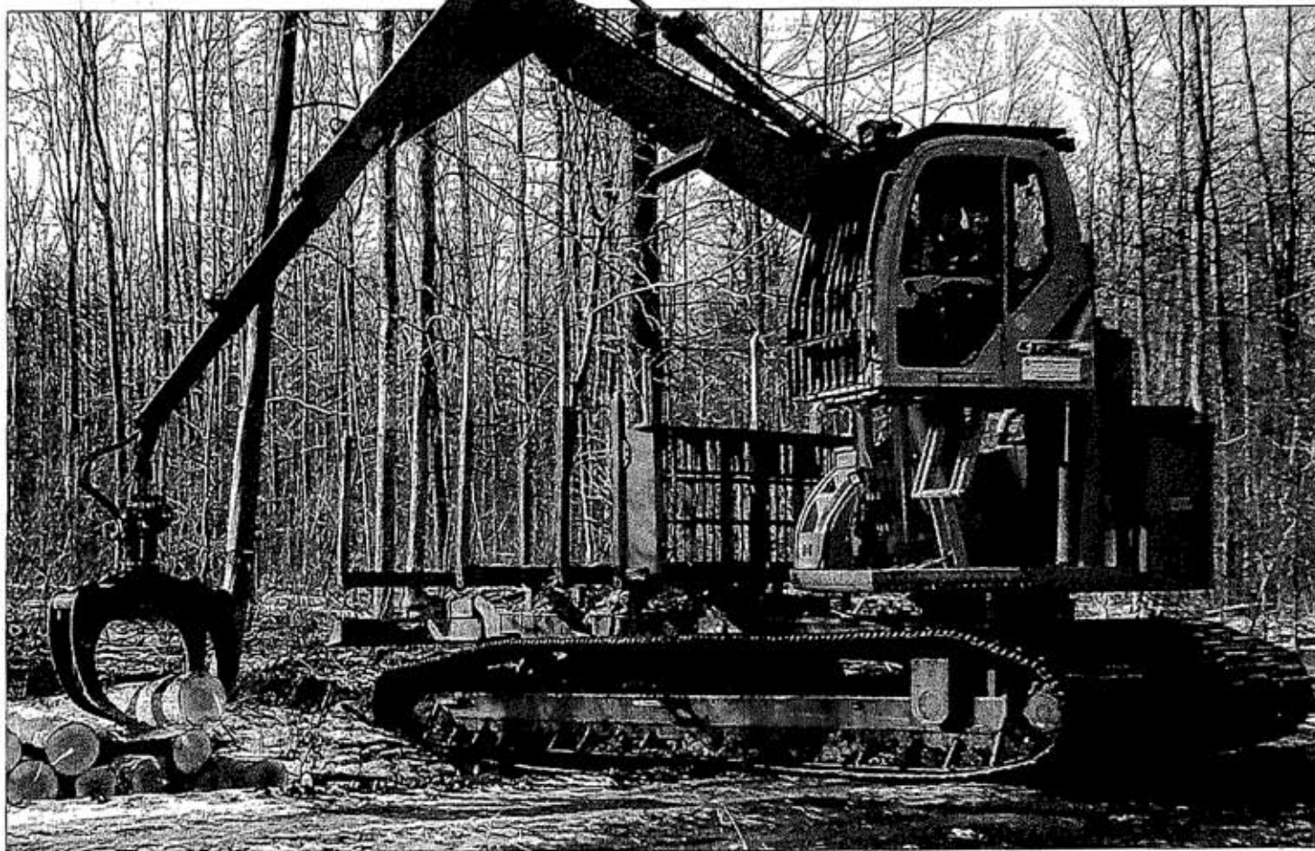
Bodenschonender Einsatz: Holzurückefahrzeug „Elliator“ arbeitet auf 100 Zentimeter breiten Ketten im Forstamt Schuenhagen.
