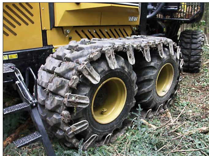
Abb. 2: Street-Rubbers-Bänder auf dem 8-Rad-Forwarder EcoLog 554C gewährleisten durch die geschlossene Bauweise eine hohe Aufstandsfläche.
