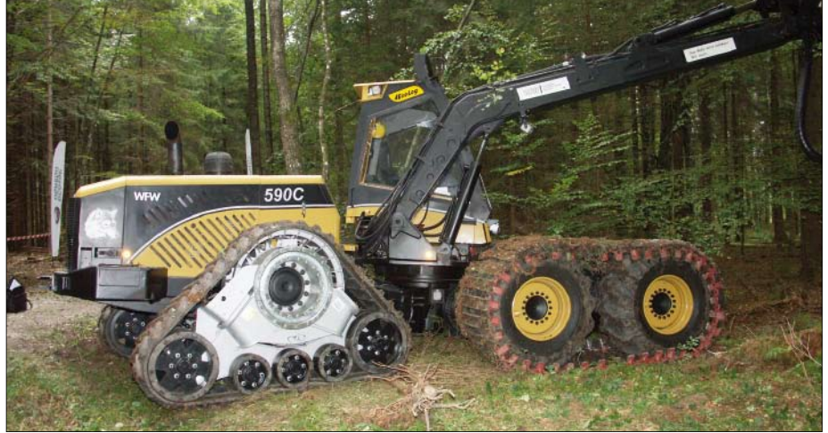
Abb. 3: Harvester EcoLog 590D mit zwei Tidue SoftTrack-24T23-Laufwerken und zwei Olofsfors EO-U-Bändern
