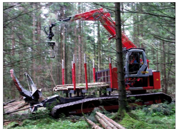
Abb. 5: EMB Elliator bringt es bei einer Aufstandsfläche von 15 m 2 auf nur 0,19 kg/cm 2 Bodendruck.
