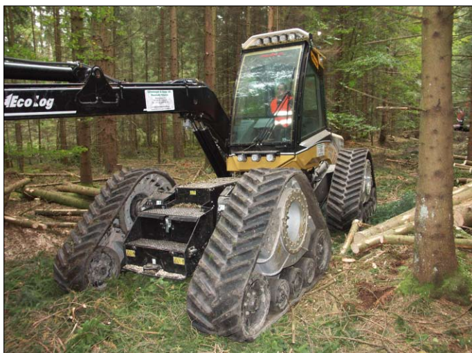
Abb. 1: Harvester EcoLog 570D mit vier Tidue SoftTrack-24T23-Laufwerken für maximalen Bodenschutz
