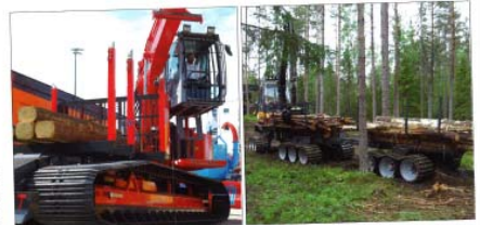
Abb. 3 und 4: Für hochsensiblen Nasstandorte gibt es bereits spezielle Raupenmaschinen als Lösungen für die Holzbringung.
