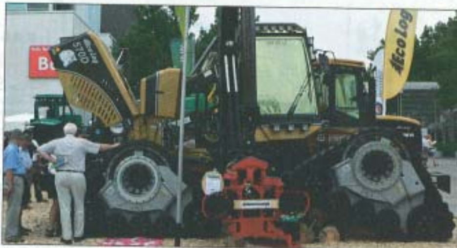
Der „Ecolog 570D“ mit vier Soft-Tracks (hier auf der „Interforst“ in München), wird während der Forsttage im Einsatz gezeigt Foto: Ißleib
