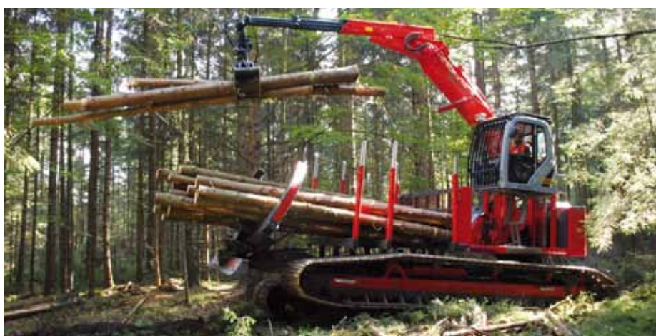
Der Elliator mit Rungenkorb, Klemmbank, Winde und pendelnd aufgehängten Laufwerken erreichte die größte Aufstandsfläche.
