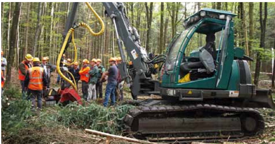
Pflegliche Durchforstungseinsätze stellte WFW anhand des Neuson Ecotec 9002 HV auf gummierten Stahlplatten, den RubberTracks, vor.
